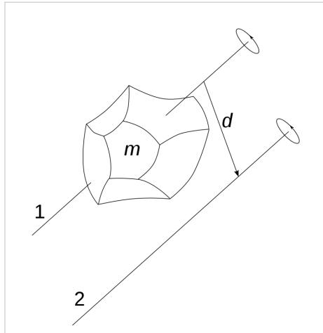
Illustration der Steiner-Regel. Drehachse 1 geht durch den Schwerpunkt des Körpers der Masse  $m$ . Drehachse 2 ist um den Abstand  $d$  verschoben.
