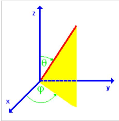
Eine Achse in beliebiger Raumrichtung wird beschrieben durch den Einheitsvektor  $\vec{e}$ . Man kann diesen z. B. dadurch erhalten, dass man den Einheitsvektor in z-Richtung mittels einer Drehmatrix  $R$  dreht:  $\vec{e} = R \cdot \begin{pmatrix} 0 \\ 0 \\ 1 \end{pmatrix}$
